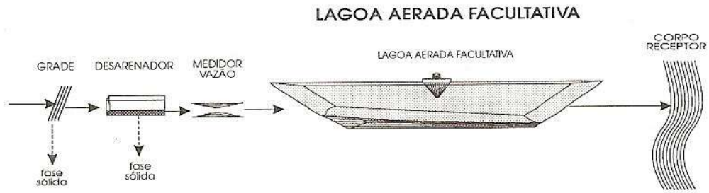
Figura 3.20 – Lagoa aerada facultativa.
